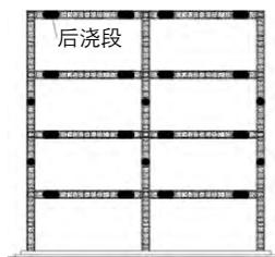
图1 新型预制装配结构体系
