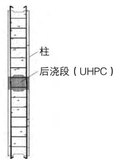
图3 柱柱节点连接
